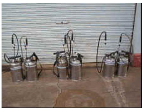
Figura 2. Pulverizadores de pressão variável, modelo Guarany®, com capacidade para 8 litros, preparados para os testes.
