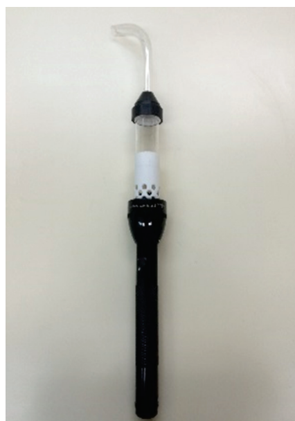
Figura. 2. Capturador elétrico para captura de alados
