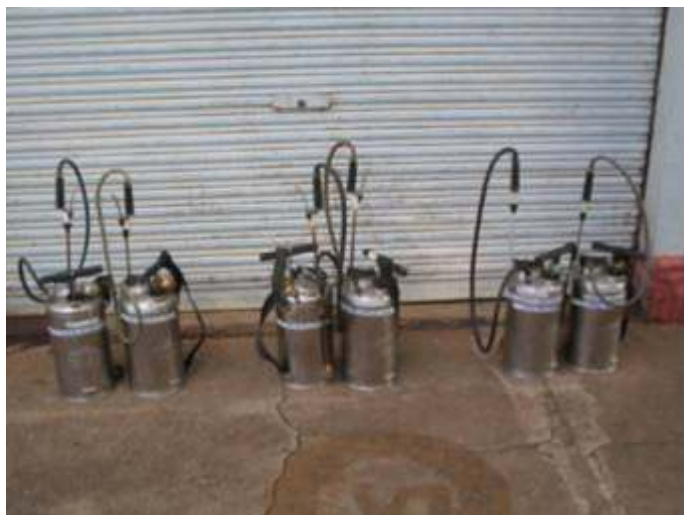
Figura 2. Pulverizadores de pressão variável, modelo Guarany, com capacidade para 8 litros, preparados para os testes.
