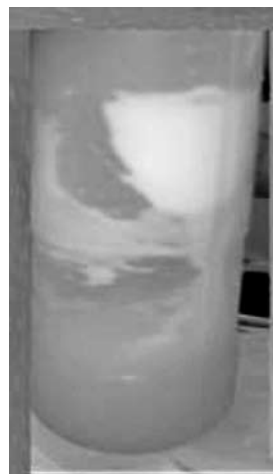
Figura 1. Demonstração da camada de gordura do leite na parede do tubo após centrifugação
