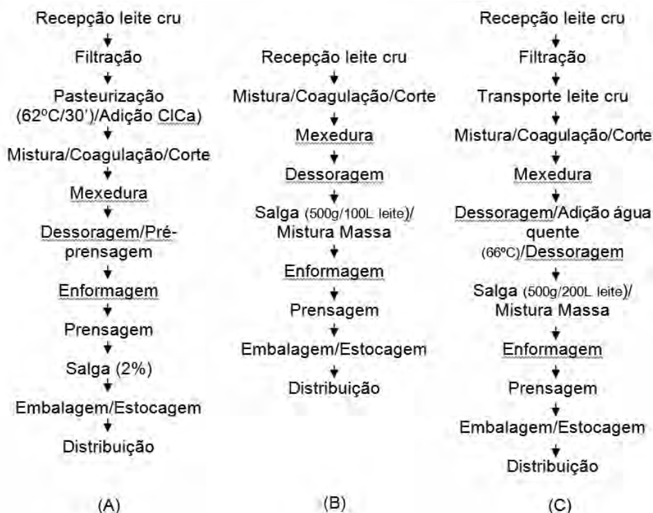
Figura 1. Fluxograma de processamento de queijo de coalho procedente de laticínios A, B e C do sertão de Alagoas
