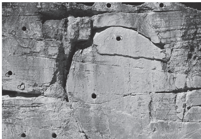
Fotografia 4 Perfurações para pesquisa geológica em afloramento do Balneário Paiuá, em Uiramutã, Roraima. Foto: Andrea Bartorelli, 2007.
